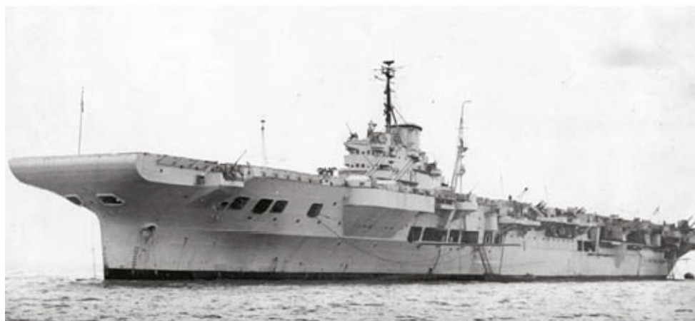
El portaviones británico Illustrious , de la serie inmediata de preguerra, fue protagonista del ataque a Tarento al dejar fuera de combate a media flota italiana; respondía a un concepto de buque con cubierta de vuelo blindada y escaso número de aviones que, aún así, demostraron ser suficientes.
